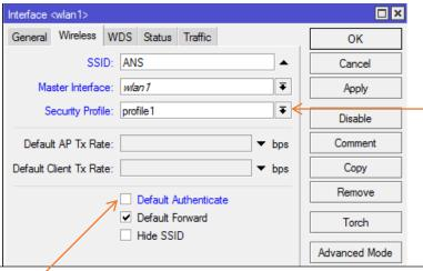
Sobre la tarjeta inalámbrica en Security Profile se selecciona el profile 1 que previamente se configuro
